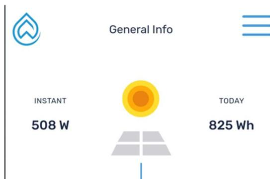
Sous le logo du panneau PV, une ligne verticale s'affiche lorsque le courant PV s'alloue à la chauffe, ou s'affiche sur le frame latéral gauche pour l'affectation à la charge de la batterie.
