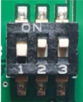
Le sélecteur 3 sert à forcer le boiler TWIN en chauffe exclusive AC et lui permet de fonctionner sans SolarConnector.
